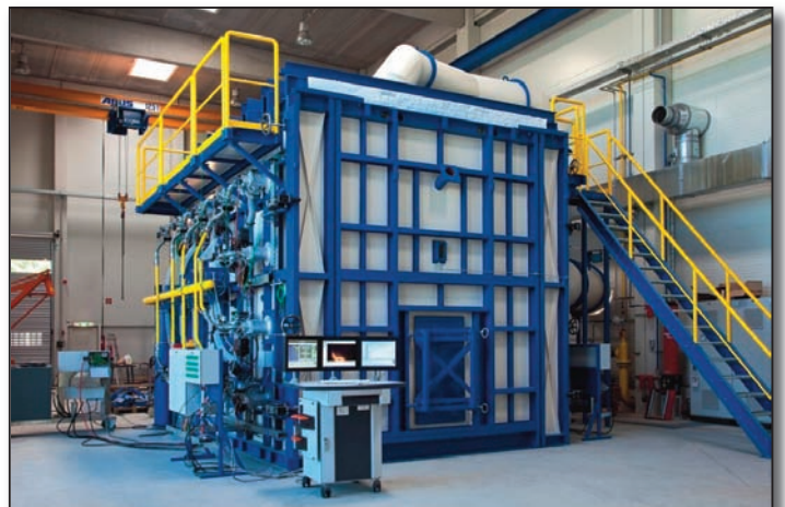
Ein Brandprüfofen mit den Außenabmessungen von 4 x 5 x 5 Meter. Die hochmoderne Steuerung erlaubt einen vollautomatischen Betrieb.
